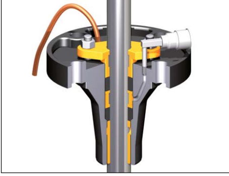
Stuffing Box Assembly Detail Salmastra Kutusu Asamblesi Detayı
